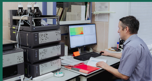
К.б.н. Д. Н. Габов проводит анализ полиароматических углеводородов на жидкостном хроматографе Маэстро ВЭЖХ.
