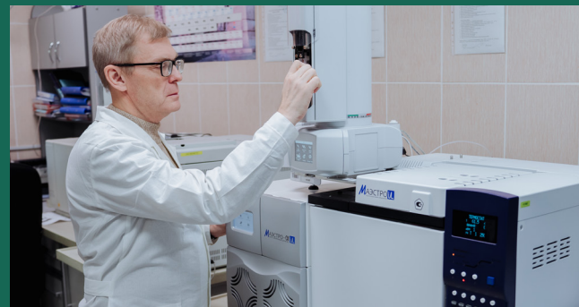
Д.х.н. И. В. Груздев выполняет анализ эфирного масла на хромато-масс-спектрометре МАЭСТРО-альфаМС.
