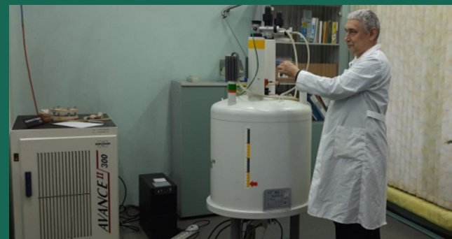
Н.с. С. П. Кузнецов проводит анализ химической структуры новых органических веществ на ЯМР спектрометре высокого разрешения Avance II 300 (Bruker).
