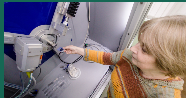
К.г.-м.н. Ю. С. Симакова за работой на рентгеновском порошковом дифрактометре DX-2700BH.
