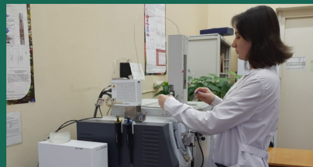
М.н.с. П. С. Некрасова исследует состав и химическую структуру продуктов органического синтеза на хромато-масс-спектрометре GCMS-QP2010Plus (Shimadzu).
