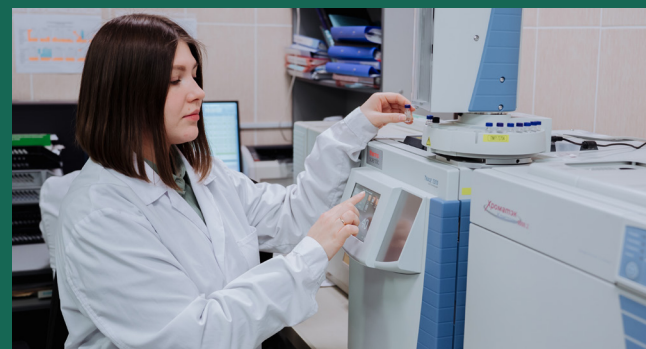
Аспирантка Е. И. Лю-Лян-Мин анализирует жирные кислоты на газовом хроматографе TRACE 1310.
