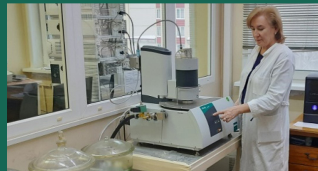
Вед. технолог С. Л. Смолева проводит высокотемпературные испытания новых материалов на приборе синхронного термического анализа STA 449 F5 Jupiter® (Netzsch).
