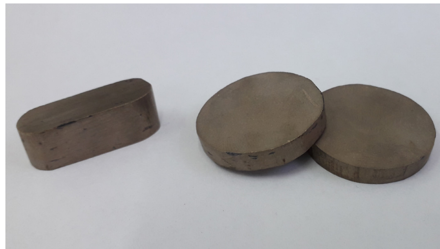
Образцы прочной высокотемпературной керамики из карбида тантала.
