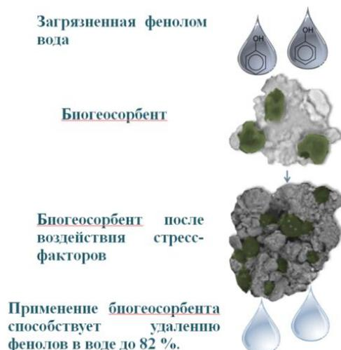
Рис. Схема очистки воды от фенолов с помощью биогеосорбента
